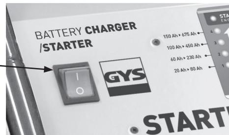
При подключении коннектора на «12В» или «24В», загорится светодиод на передней панели как подтверждение выбранного параметра. Если выбранное напряжение не соответствует напряжению АКБ, зарядка не начнется.
