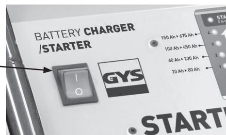
Une fois le connecteur branché sur «12V» ou «24V», une LED s'allume sur l'interface pour bien confirmer l'entrée choisie. Si la tension choisie ne correspond pas à la tension de la batterie, la charge ne pourra pas commencer.
